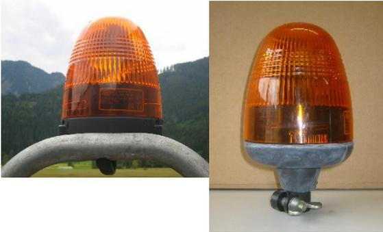
fix montierte Hella Drehleuchte
