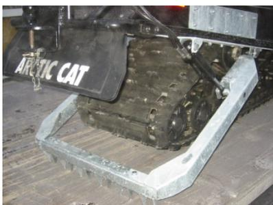
Elektrohydraulisch betriebene Heckbremse
