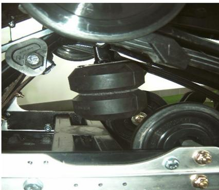
Zusatzfederung für Laufwerk mit zentraler Gummihohlfeder
