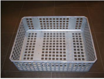
Innenmaß: B:820 mm T:620 mm H:270 mm, Stanzblech mit Stahlrohrrahmen, verzinkt
