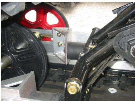
Anschlagpuffer für Laufwerk
