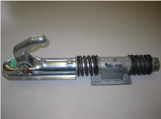
Kugelpkopfaufnahme drehbar (50 mm Kugel)
